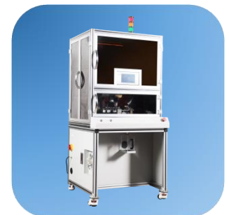
HBQ-106 散粒航空端子剥打 一体工作站
